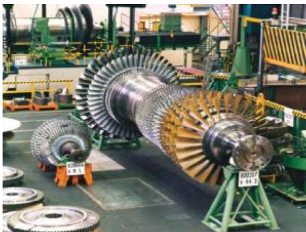
Plynová Turbína SGT5-4000F ve výrobním závodě SIEMENS
